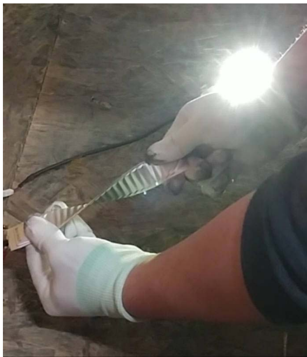
<아모그린텍 플렉시블 배터리. 배터리를 좌우로 틀어도 전구에 불이 들어오고 있다.>
